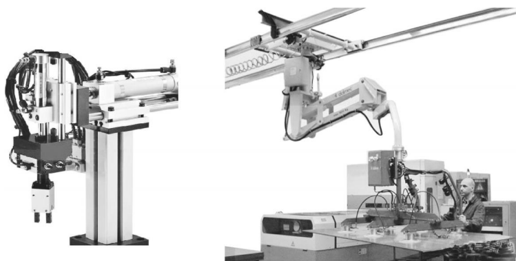
图 8-1 工业自动化生产线上的气动机械手
