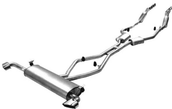
图 9-28 宝马 X5 系列轿车排气系统及消声器
