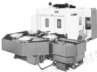
图 11-3 带有自动换刀装置的 FMS (柔性制造系统)
