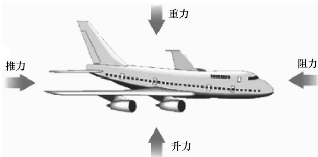
图 2-10 飞机通过四种力量交互作用飞上天空
