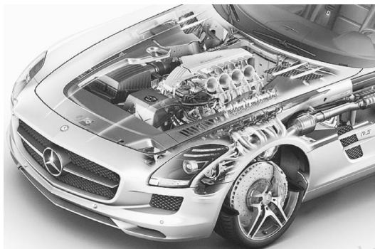
图 3-11 奔驰的双涡轮增压 V8 发动机外观
