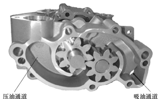
图 3-24 保时捷卡宴 V8 发动机 润滑系统上的齿轮泵
