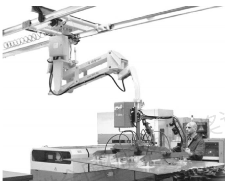
图 1-8 工业自动化生产线上的气动机械手
